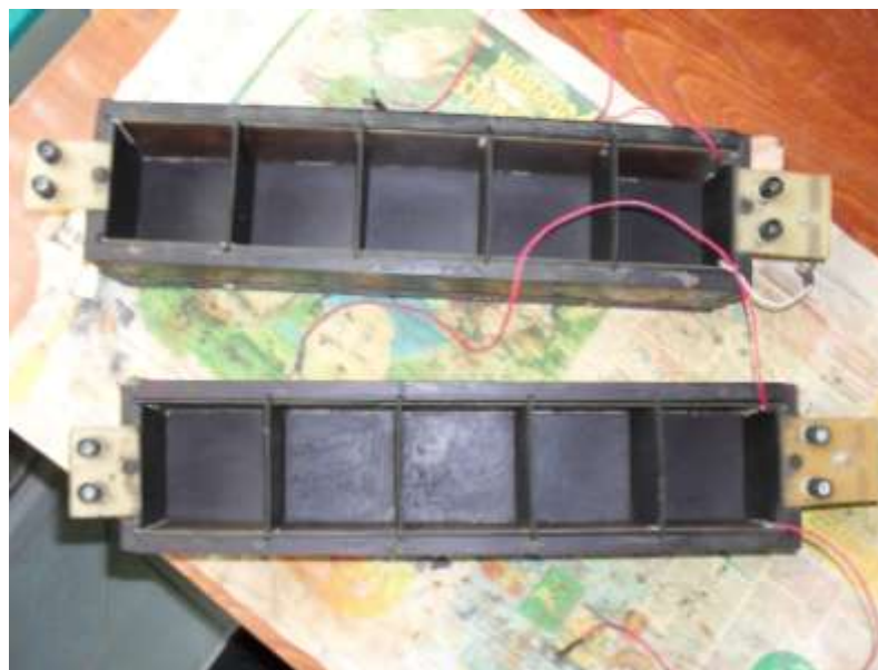
Рис. 1. Формы из диэлектрического материала с плоскими металлическими электродами
