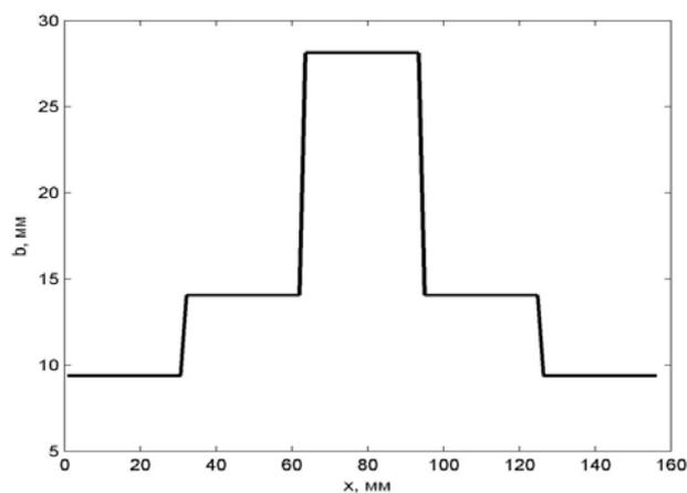
Рис.1. - График изменения ширины сечения  $b$
