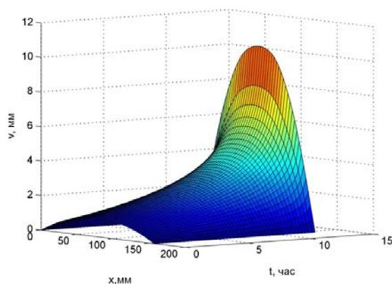
Рис. 3. - График изменения стрелы прогиба для стержня переменного сечения
