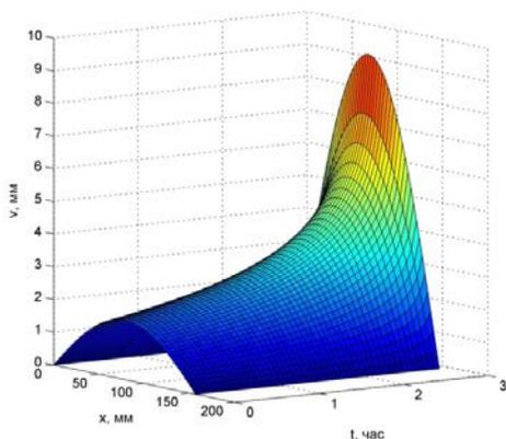
Рис. 2.- График изменения стрелы прогиба для стержня постоянного сечения
