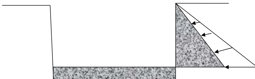
Рис. 1. – Котлован с закрепленными стенками и дном
