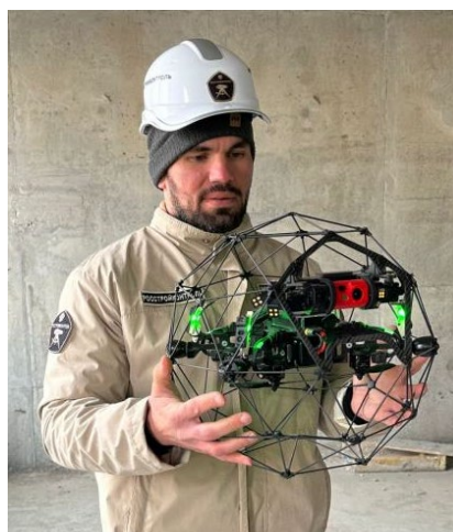
Рис. 1. – Модель зарубежного беспилотного летательного аппарата, используемого для выявления дефектов здания
