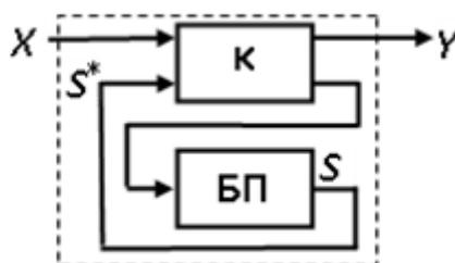
Рис. 1 – Структура конечного автомата
