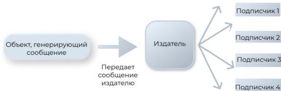
Рис. 1. – Схема работы паттерна «MessageBroker»
