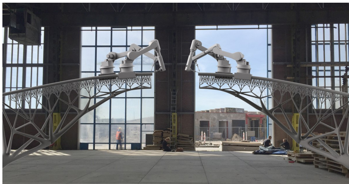
Рис. 4 – Малогабаритный промышленный робот, разработанный компанией MX3D
