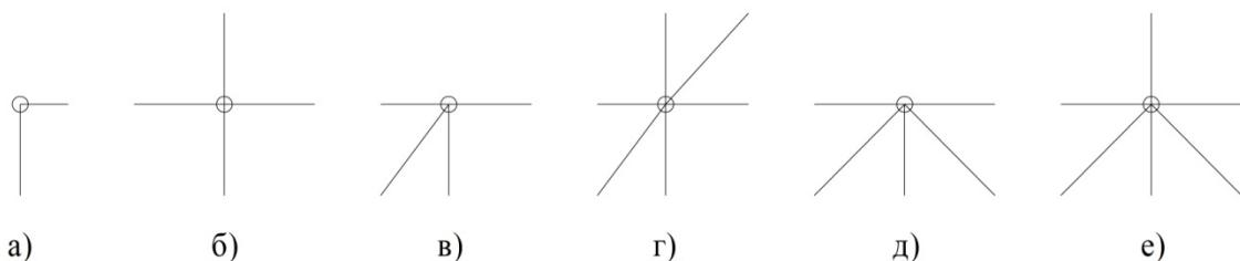
Рис. 1. Число элементов в узлах в плане круговой цилиндрической сетчатой оболочки: а – два; б, в – четыре; г, е – шесть; д – пять; кружочками показаны узловые вставки
