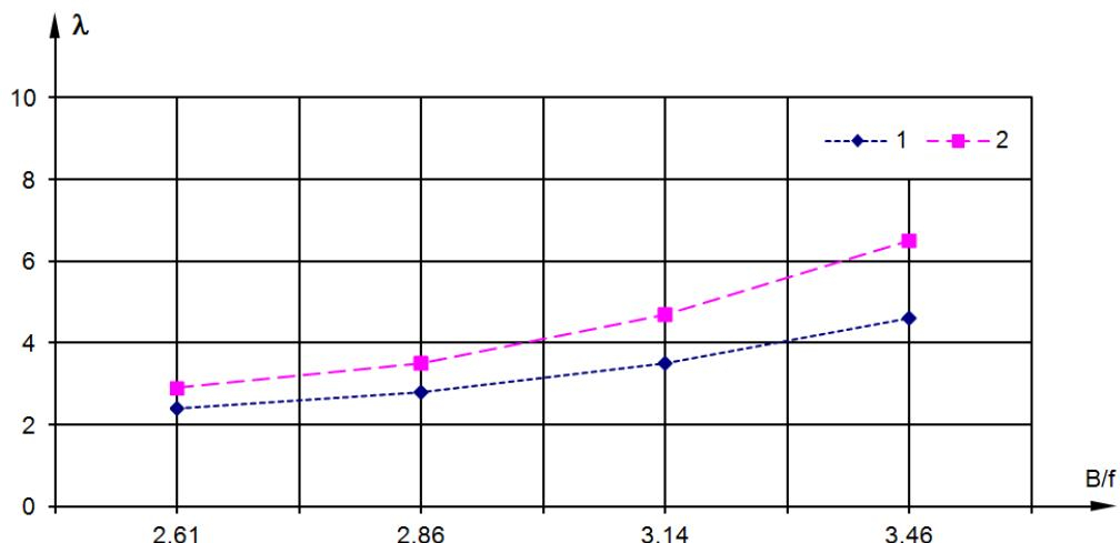
Рис. 3. Динамика изменения коэффициента запаса устойчивости  $\lambda$  в зависимости от  $B/f$  круговой цилиндрической сетчатой оболочки с ячейками: 1 – квадратными; 2 – прямоугольными
