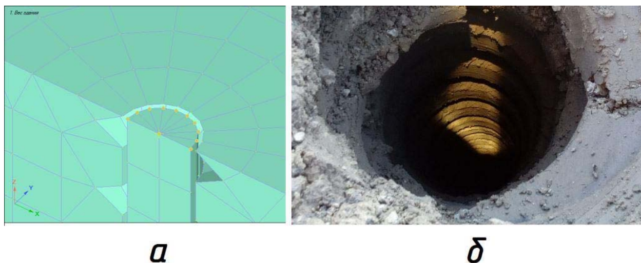
Рис. 2. – Конечно-элементная модель оголовка сваи, а – конечно-элементная модель, б – физическое исполнение раскатанной резьбы.
