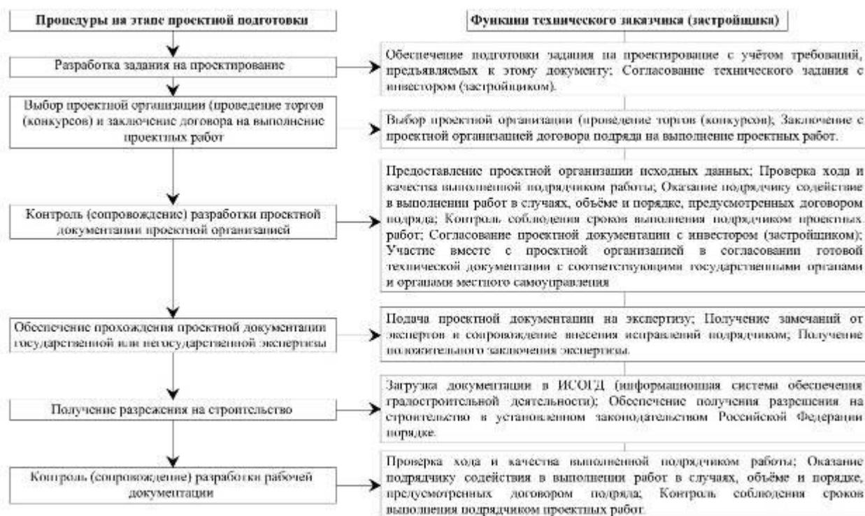
Рис. 2 - Схема увязки процедур и функций технического заказчика (застройщика) на этапе проектной подготовки объекта к строительству
