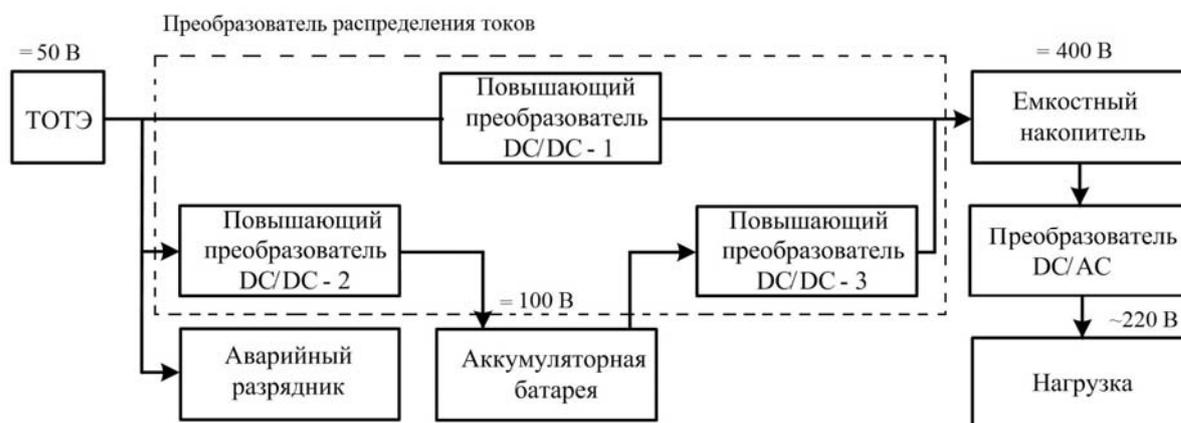
Рис. 3. Структурная схема преобразователя распределения токов
