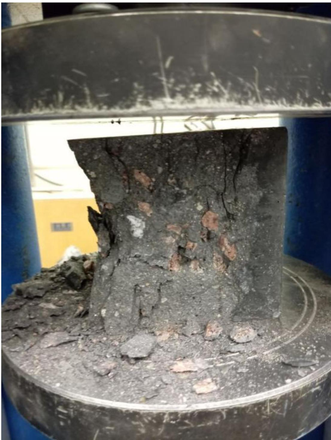
Рис. 2. – Характер разрушения сжатого образца
