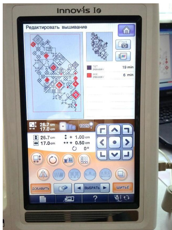
Рис. 2 – Экран швейно-вышивальной машины на этапе технической настройки
