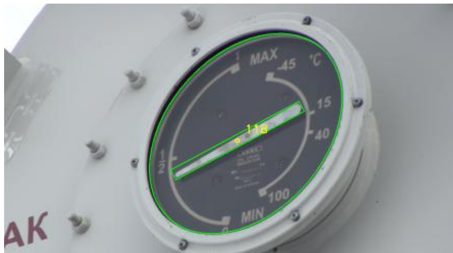
Рис. 8. – Пример результата работы программы по нахождению значения уровня масла
