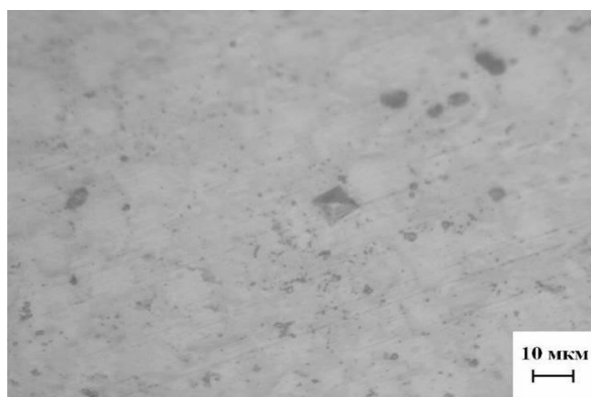
Рис. 2. – Отпечаток индентора вблизи границы сплавления образцов, выполненный методом газопорошковой наплавки (высота защитного покрытия образцов h = 1,0-1,2 )
