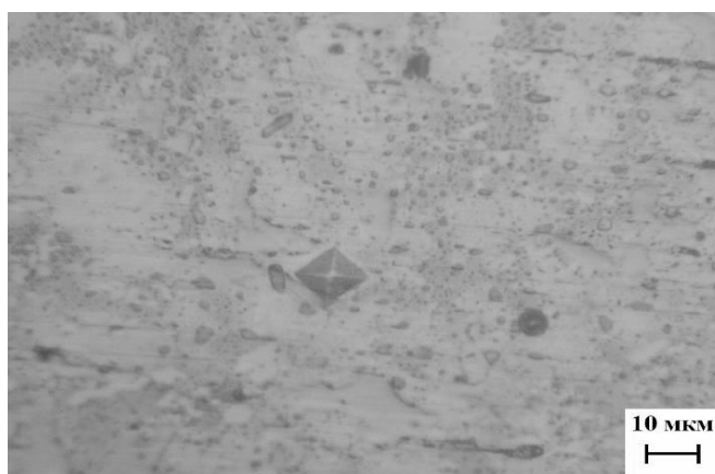
Рис. 1. – Отпечаток индентора на наплавленном покрытии образцов, выполненный методом газопорошковой наплавки (высота защитного покрытия образцов h = 1,0-1,2 )
