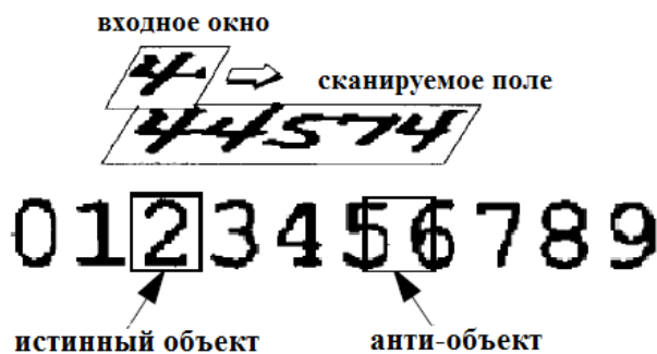
Рис. 2. – Блочное распознавание с помощью «скользящего окна»
