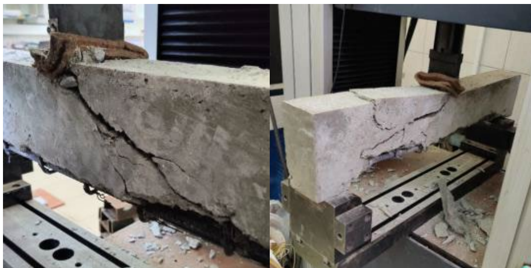
Рис. 11. – Разрушение балок с невосстановленным защитным слоем
