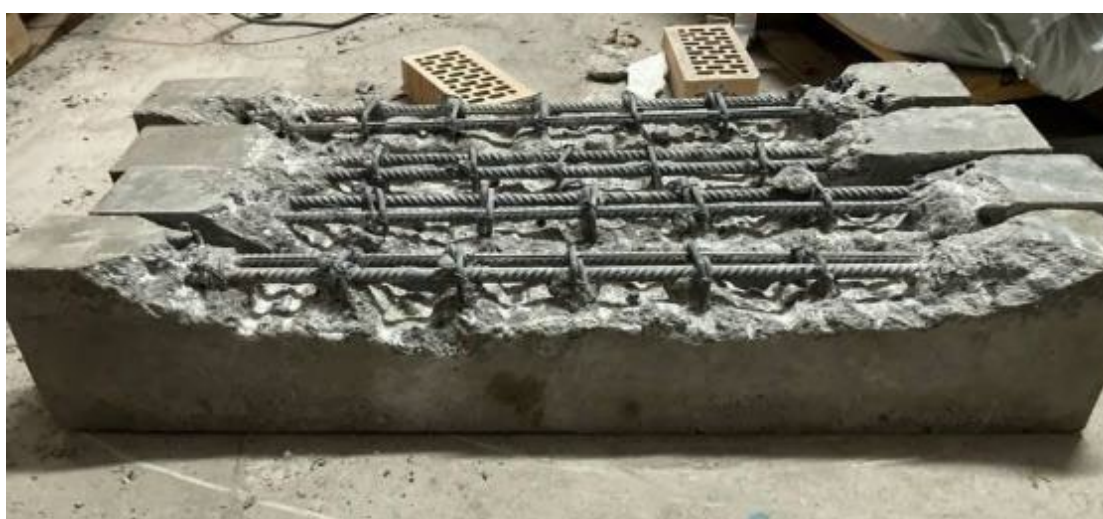
Рис. 8. - Балки с «тарированными» дефектами
