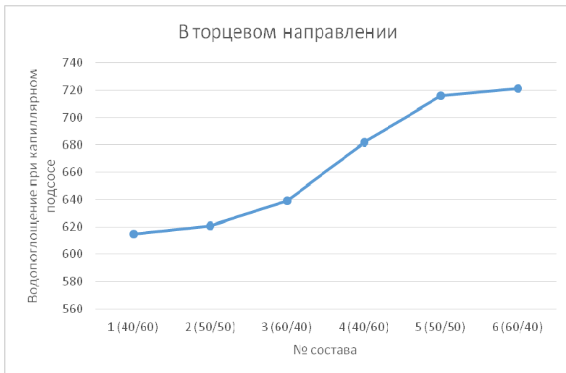
Рис. 2. – Результаты исследования водопоглощения при капиллярном подсосе образцов центрифугированного бетона в торцевом направлении
