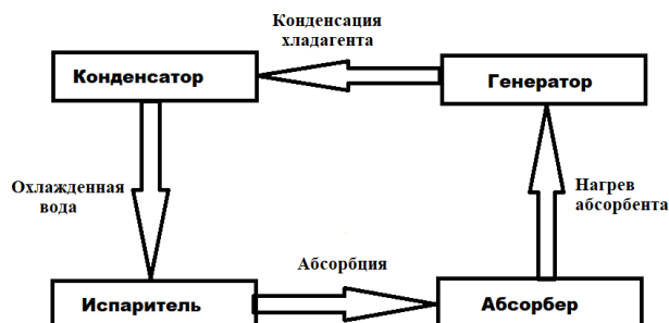
Рис.– 3. Цикл работы АБХМ
