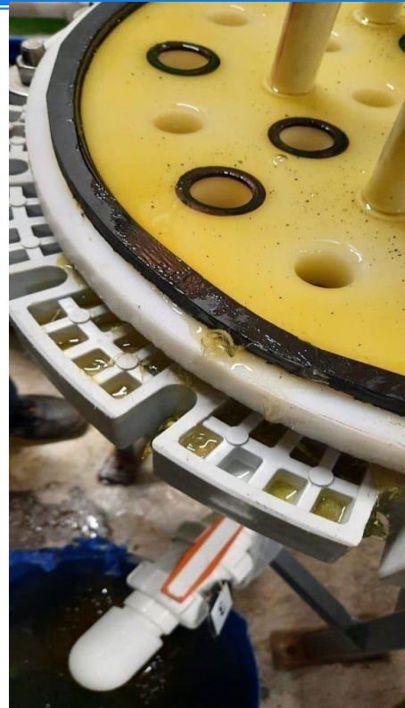
Рис. 16 – Место протекания раствора полимера.
