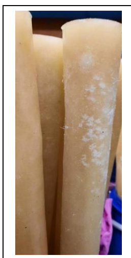
Рис. 21 – Дуговая деформация фильтр-элемента.
