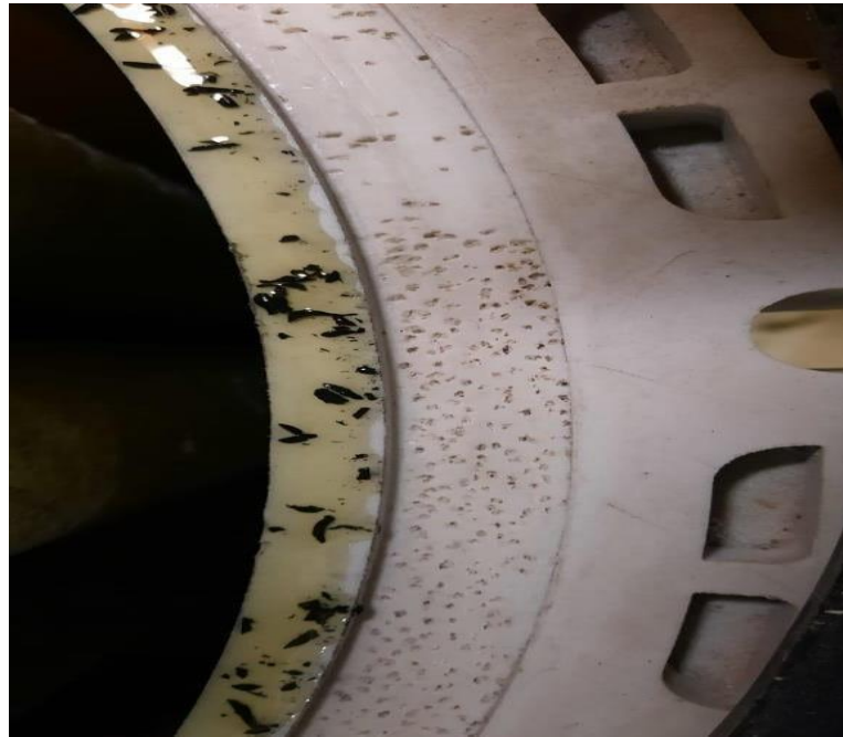
Рис. 9 – повреждения корпуса нижней обечайки фильтра На диске для крепления оснастки находились поврежденные части резиновых прокладок, а также резиновые уплотнительные кольца, которые устанавливались на колпачки для крепления картриджей (Рис. 10)
