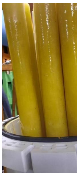
Рис. 22 – Деформированные фильтр-элементы. Для визуального осмотра структур отработавших фильтр-элементов, они были разрезаны (Рис. 23).
