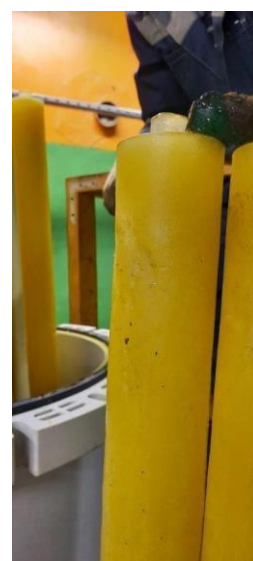
Рис. 22 – Деформированные фильтр-элементы. Для визуального осмотра структур отработавших фильтр-элементов, они были разрезаны (Рис. 23).
