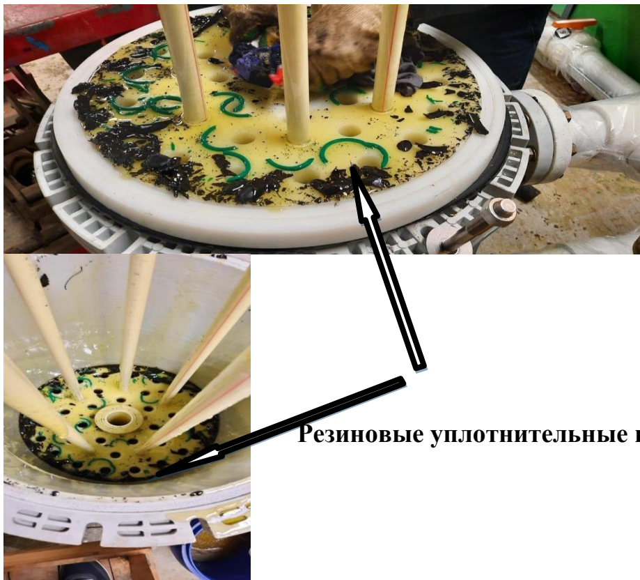
Рис. 9 – повреждения корпуса нижней обечайки фильтра На диске для крепления оснастки находились поврежденные части резиновых прокладок, а также резиновые уплотнительные кольца, которые устанавливались на колпачки для крепления картриджей (Рис. 10)
