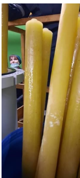
Рис. 22 – Деформированные фильтр-элементы. Для визуального осмотра структур отработавших фильтр-элементов, они были разрезаны (Рис. 23).
