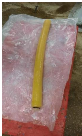
Рис. 21 – Дуговая деформация фильтр-элемента.
