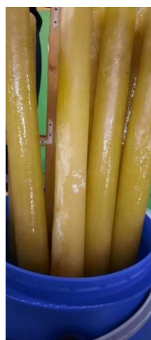
Рис. 21 – Дуговая деформация фильтр-элемента.
