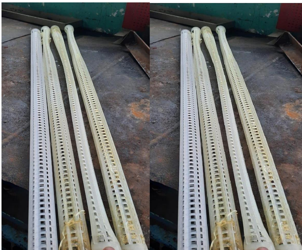
Рис. 28 – Деформированная втулка фильтр-элементов
