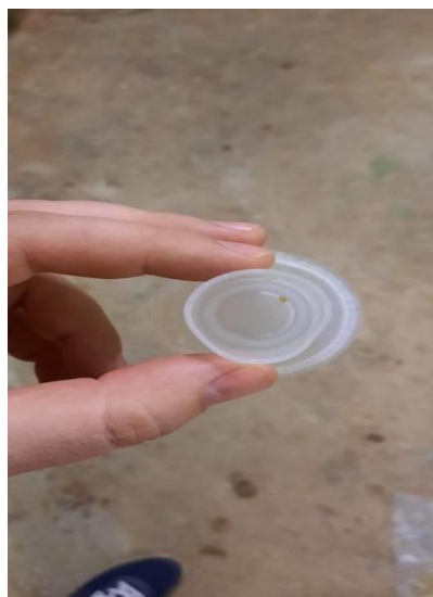
Рис. 33 – Деформированный колпачок крепления фильтр-элемента.
