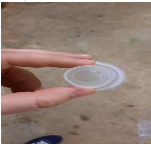
Рис. 20 – Деформированный колпачок крепления фильтр-элемента.
