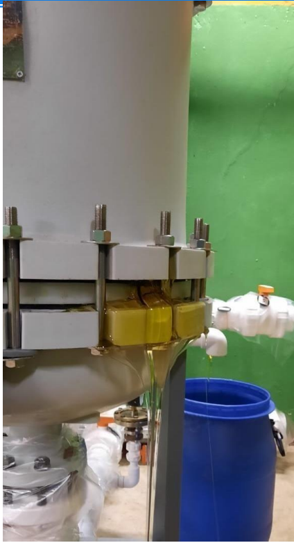
Рис. 16 – Место протекания раствора полимера.
