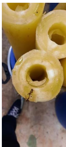
Рис. 21 – Дуговая деформация фильтр-элемента.
