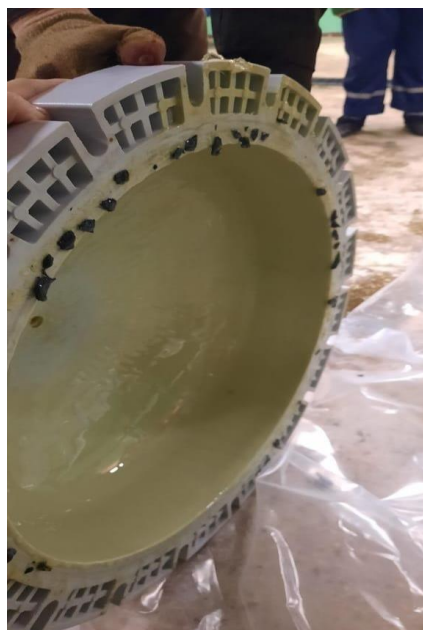
Рис. 7 – частицы резиновой прокладки на крышке фильтра.
