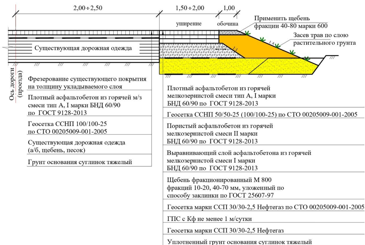
Рис. 4. – Конструкция уширения проезда
