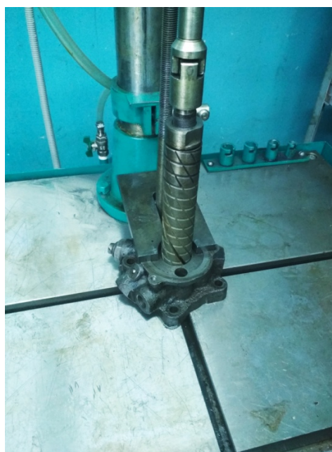
Рис. 3. – Обработка корпуса распределителя ГУР
