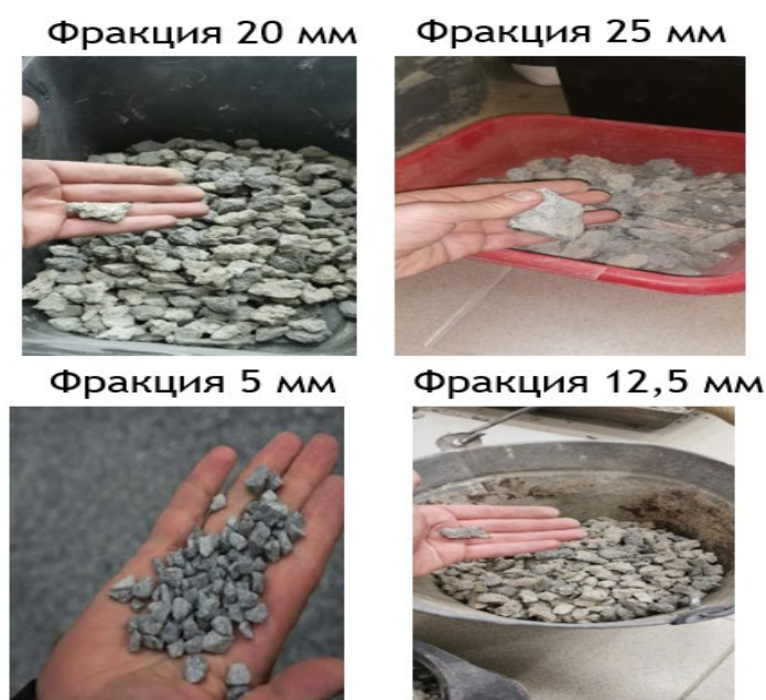
Рис. 5. – Определение гранулометрического состава вторичного щебня
