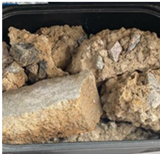
Рис. 4. – Бетонный лом со строительного объекта
