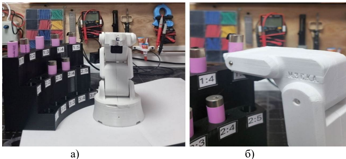
Рис. 3. - Внешний вид ПРМ с двухпальцевым захватом (а) установка аккумулятора в СК (б)
