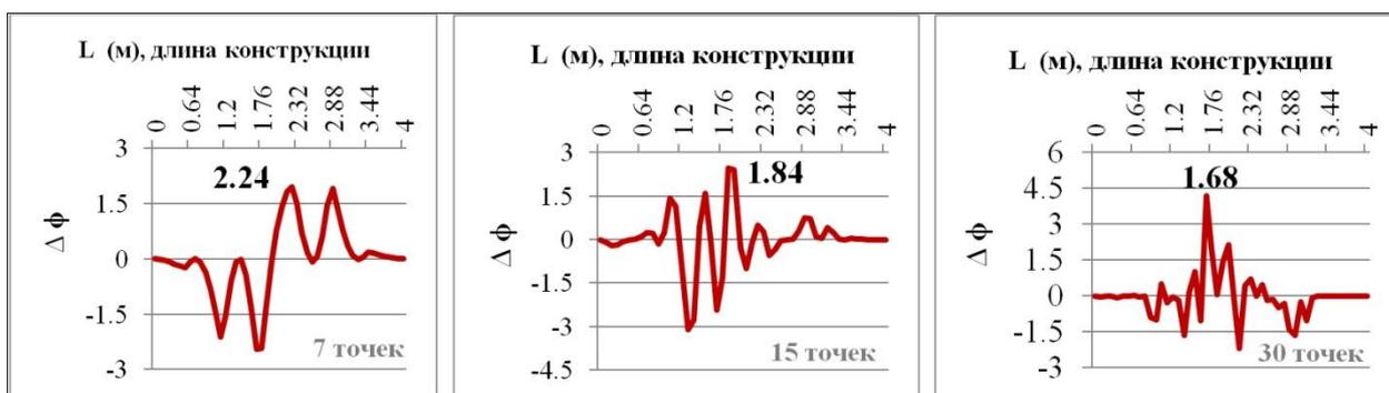
Рис. 2. – Локализация повреждения при помощи метода изменения индекса конструкции
